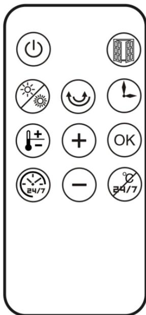
**Рис.4 Управление прибором при помощи пульта ДУ**
